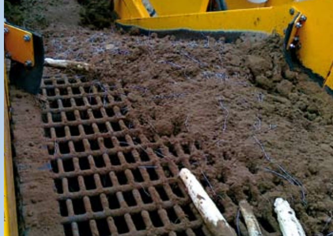
Die ab 2012 verwendete Siebkette ist engmaschiger
